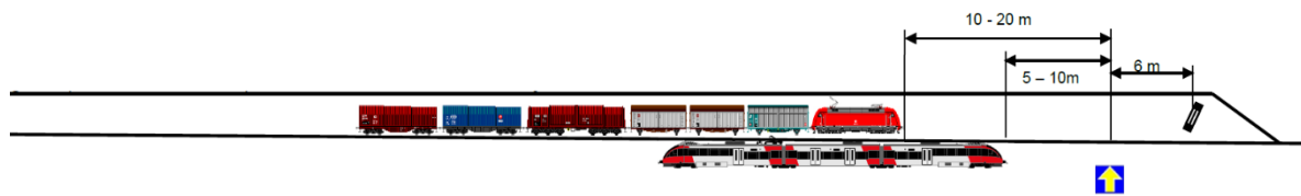
Abbildung 2: Auswirkungen eines Gefahrenpunktabstands von 6 m (Quelle: ÖBB-Infrastruktur AG)
