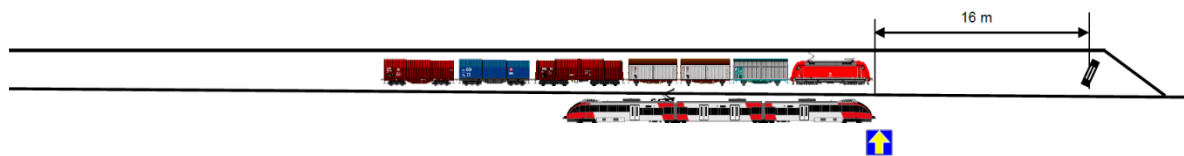
Abbildung 3: Auswirkungen eines Gefahrenpunktabstands von 16 m (Quelle: ÖBB-Infrastruktur AG)
