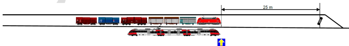
Abbildung 4: Auswirkungen eines Gefahrenpunktabstands von 25 m (Quelle: ÖBB-Infrastruktur AG)
