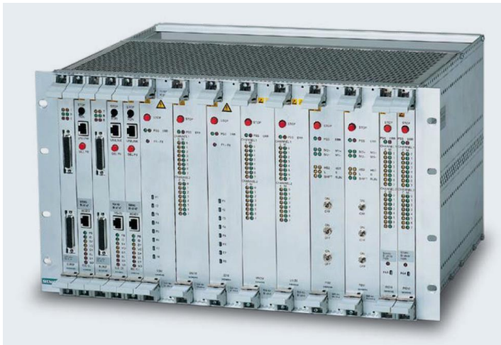
Abbildung 1: Stellwerksrechner eines ESTW (Quelle: Siemens AG, Mobility Division)
