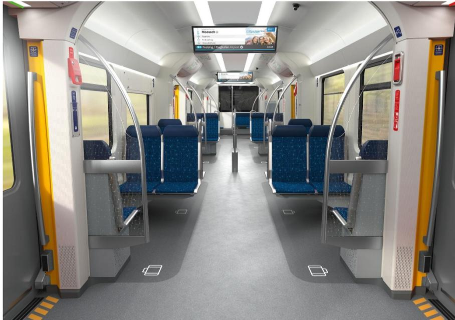
Abbildung 8: Einstiegsbereich mit "Trichter" (Quelle: Deutsche Bahn)
