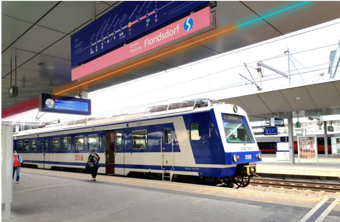
Abbildung 17: Fotomontage - LED-Leuchtband zur Fahrgastlenkung am Bahnsteig
