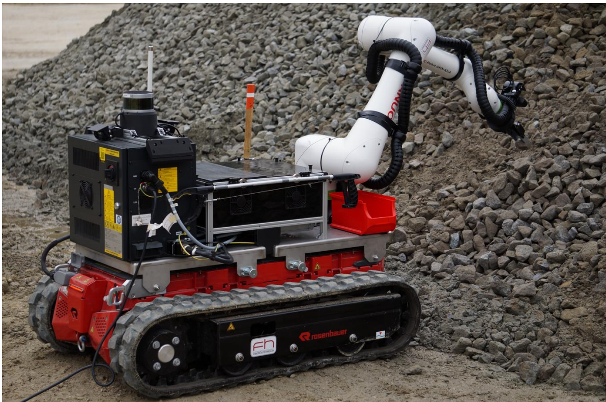
Abbildung 3: Roboterplattform beim Manipulieren von Gesteinsmaterial für die AMADEE24
