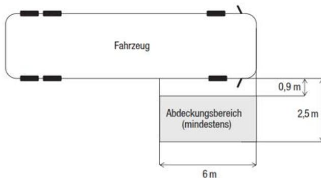
2.2 Optische Signalisierung von gefährdeten Radfahrenden mindestens im Abdeckungsbereich; die Signalisierung muss im Innenraum des Kraftfahrzeugs erfolgen; eine zusätzliche akustische Signalisierung im Innenraum des Kraftfahrzeugs ist erlaubt. Signalisierung bei Fahrzeuggeschwindigkeiten mindestens im Bereich vom Stillstand bis 30 km/h, bei Fahrradgeschwindigkeiten mindestens im Bereich von 5 km/h bis 20 km/h.
